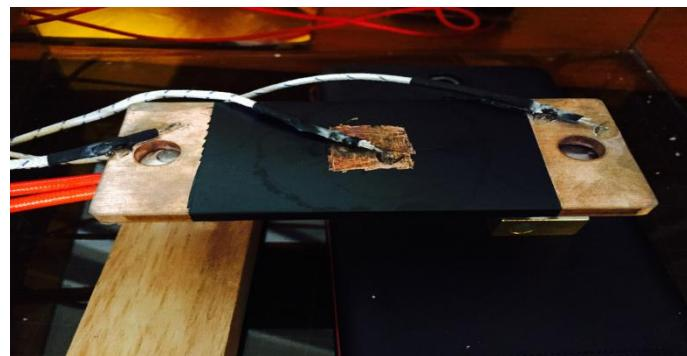
喷涂散热涂料后铜排平均降温5°C，且两段温差由0.7增加到2.3°C
